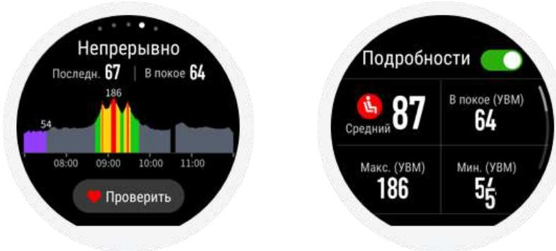
При включенном режиме «Суточный мониторинг пульса» приложение показывает значение Вашего пульса в минуту (bpm), а также среднее, максимальное и минимальное значения пульса в сутки в нетренированном состоянии, значение пульса в состоянии покоя (необходимо носить часы во время сна).
