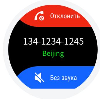
Оповещение о входящих вызовах на часах находится во включенном состоянии по умолчанию, не требует настройки. На часах будет отображаться оповещение о входящем вызове в случае входа вызова в телефон при подключении часов к телефону. На часах можно осуществлять отключение входящего вызова или молчание входящего звонка.
