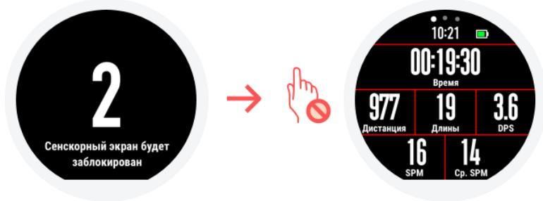
В целях предотвращения случайного нажатия пальцем по сенсорному экрану и защиты сенсорного экрана от помех водой, после начала плавания наблюдается автоматическое закрытие функции сенсорного экрана. При этом можно осуществить управление плаванием при помощи функциональных кнопок часов. После окончания плавания часы повторно запускают функцию сенсорного экрана.
