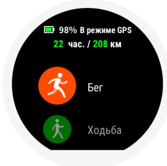
После разблокировки циферблата можно нажать на среднюю кнопку для быстрого открытия списка тренировок, затем выбрать нужный вид тренировки путем перехода пальцем вверх и вниз по экрану или нажатия кнопок "Вперед" и "Назад". Далее нажмите на выбранный вид тренировки или нажмите на среднюю кнопку для пуска выбранного вида тренировки.
