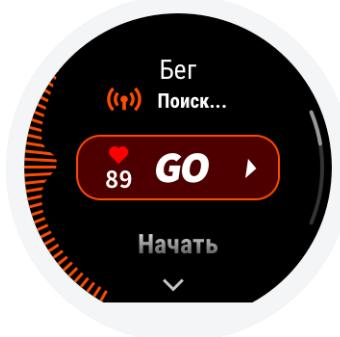
После входа в страницу готовности к бегу часы автоматически осуществляют поиск GPS. После обнаружения GPS следует щелкнуть кнопку «GO» или нажать на среднюю кнопку для начала бега и отсчета времени.
