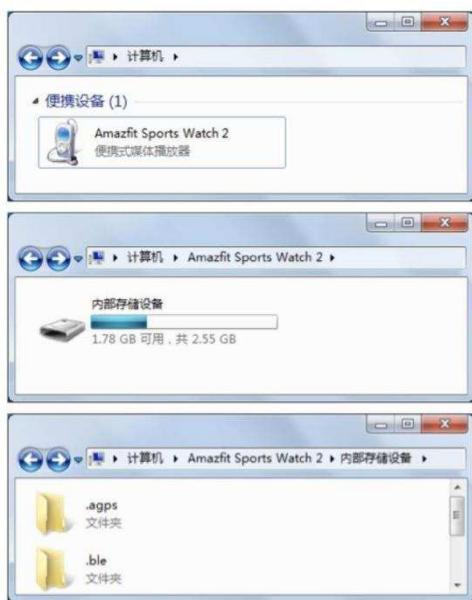
Подключив часы, соединенные с разъемом, к интерфейсу USB компьютера, двойным щелчком мыши нажмите на «Amazfit Sports Watch» на странице «Мой компьютер», затем нажмите двойным щелчком мыши на «Внутреннее запоминающее устройство» для доступа к файлам на часах.
