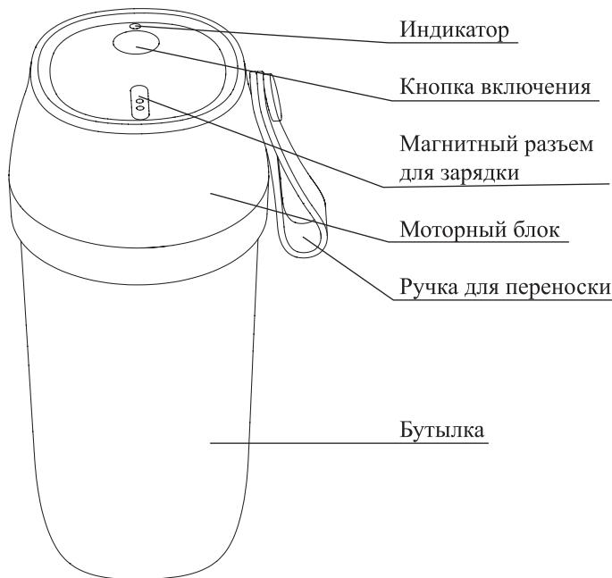
Устройство запускается двойным нажатием на кнопку включения. Это предотвращает случайное включение блендера в сумке, если на кнопку надавит соседний предмет.
