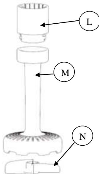
L. Перехідник насадки для приготування картопляного пюре
